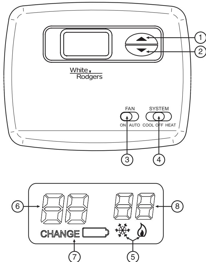
Figura 8. Pantalla, botones e interruptores del termostato
