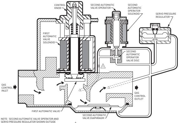
SERVO PRESSURE REGULATOR SHOWN OUTSIDE GAS CONTROL FOR EASE IN TRACING GAS FLOW.
