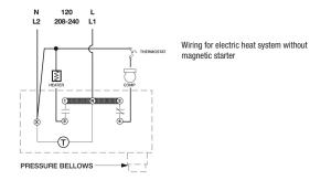
Models 8141-00, 8141-20 -Wiring Diagram
