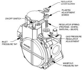
Fig. 29 – Single-Stage Gas Valve
