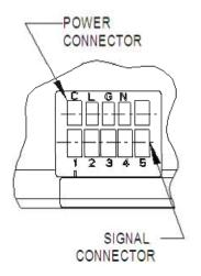
Fig. 24 – Constant Torque Module Plug
