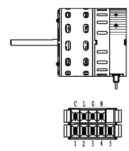
Fig. 25 - Digi Motor Module Plug
