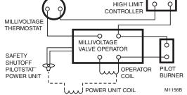
Fig. 27. Typical Powerpile<sup>®</sup> System wiring diagram.
